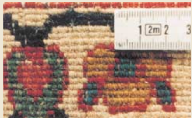
Sy3: ein sichtbarer Höcker ist ein Knoten. Knotendichte = 40 x 50 Knoten auf 10 cm 2 .
