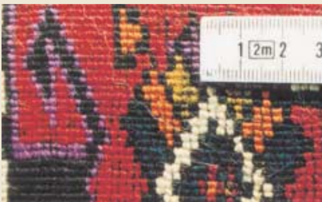
Sy1: zwei sichtbare Höcker sind ein Knoten. Knotendichte = 30 x 40 Knoten auf 10 cm 2 .
