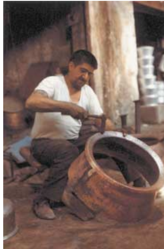
Der Kupferschmied beim Bearbeiten eines Kupfer-Käsekessels.
