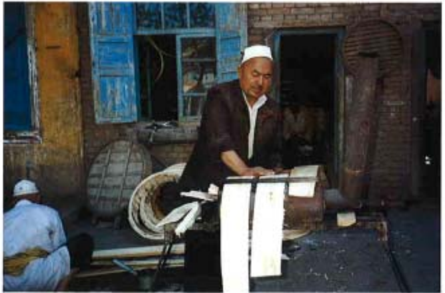
Artisans occupés à la fabrication d'un appareil de cuisson à la vapeur destiné à la préparation de "ravioli".
