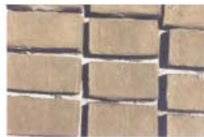
Les briques sont mises à sécher.
