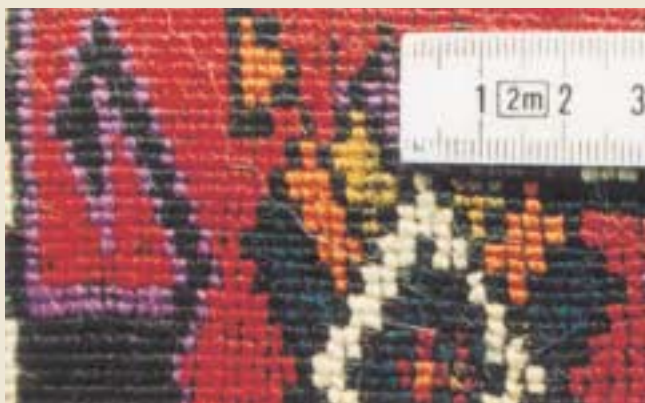
Sy1 deux boucles visibles constituent un noeud. Finesse = 30 x 40 noeuds /10 cm 2 .
